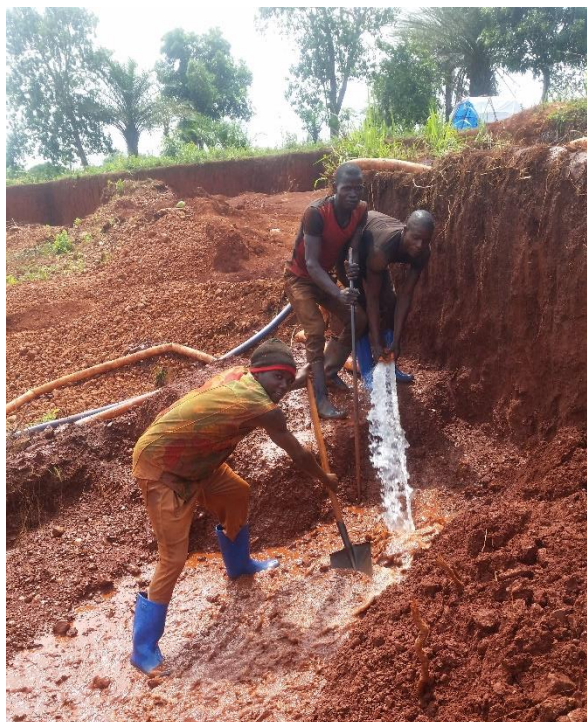
Photo 20 : Utilisation de l'eau pour extraire l'or (technique sukura) (Yesu aza bien, Haut-Uele)
