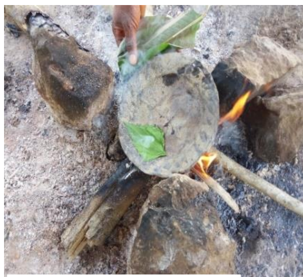
Photo 50 : Utilisation des feuilles pour capturer le mercure
