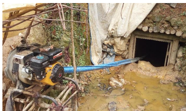
Photo 10: Entrée d'un tunnel d'extraction souterraine, avec un compresseur l'oxygène
