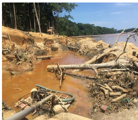
Photo 22: Tuyau relié à un moteur qui aspire le sable à la carrière Avakubi (Tshopo)
