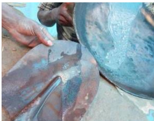
Photo 53: L'or de la concentration gravimétrique, on peut obtenir de l'or visible et directement récupérable (à gauche) ; et concentré nécessitant un traitement au mercure (à droite).
