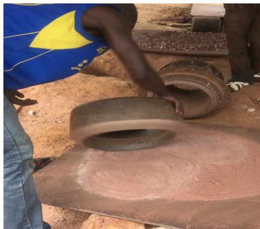
Photo 30 : Concassage à l'aide d'une pièce circulaire lourde à la carrière Yindi dans l'Ituri
