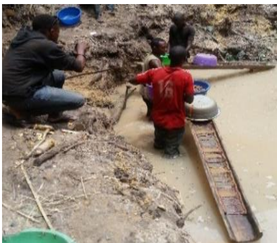
Photo 46 : Concentration du minerai par gravimétrie
