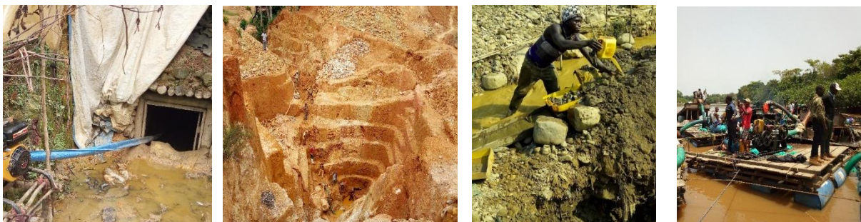
Photo 11-14 : Type d'extractions : (photo 11) extraction souterraine (avec un compresseur pour alimenter le fond du puits en oxygène), (photo 12) extraction alluvionnaire à ciel ouvert, (photo 13) extraction alluvionnaire sur rivière barrée & (photo 14) extraction sur dragues
